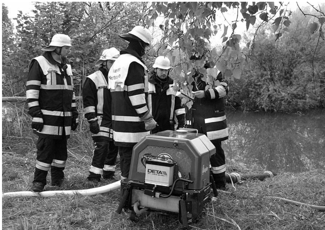
Beim Maschinistenkurs wird den Teilnehmern die Funktionsweise von Tragkraftspritzen erklärt
