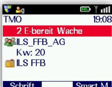
Statusquittungen werden automatisch im Display angezeigt bzw. können über die Taste "verpasste Ereignisse" abgerufen werden.
