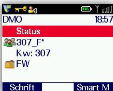
Die Tastensperre wird automatisch oder mittels der Stern-Taste (\* ca. 2 Sek. drücken) aktiviert und deaktiviert.
