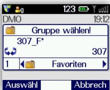
Der Gruppenwechsel kann durch einmaliges kurzes Drücken der Mode-Taste aufgerufen werden.
