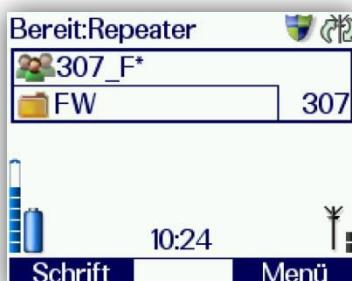
Sofern das Gerät mit einer Repeater-Lizenz ausgestattet ist wird ein aktiver Repeater-Betrieb über ein zusätzliches Symbol im Betriebszustand sowie über eine Textmitteilung in der obersten Display-Zeile signalisiert.
